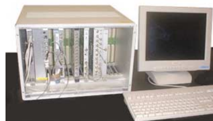
ソフトウェア無線 ソフトウェアの変更により再構築が可能なマルチモード無線端末
